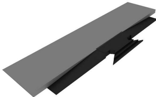
Tablado externo, rampas, patamar e escadas com estrutura metálica interna dimensionada para tal fim, revestidos com chapa de *madeirite* resinada preta **E14** mm, com acabamento de piso em manta de borracha antiderrapante 3mm, liso (foto).
