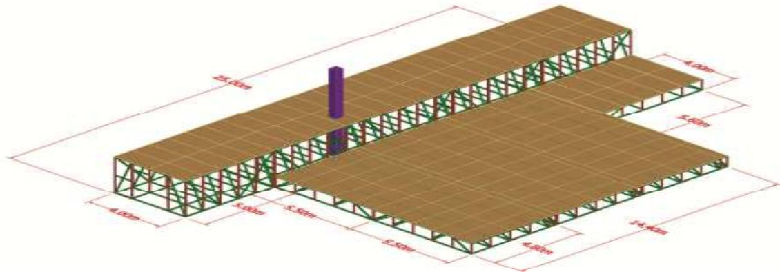
**3.1.** A primeira parte é composta por 03 (três) módulos iguais descrito na prancha **PALCO 3**, e um módulo descrito na prancha **PALCO 4**. Cada módulo é formado por 06 (seis) pórticos.
