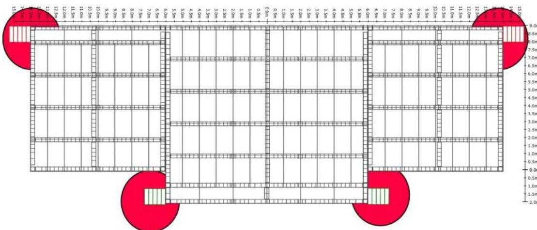
3.3.2. Deverá ser construída atrás do painel de LED uma área de escape nivelada ao palco de 4m de profundidade x 20m de largura x 0,90cm de altura com mesmo acabamento do palco e guarda corpo. Esta área servirá para manobrar os elementos cênicos novos. Também deverá ser construída rampa fixa de acesso para essa área com 3m de extensão por 2m de largura x 0,90cm de altura com piso pintado de preto antiderrapante.
