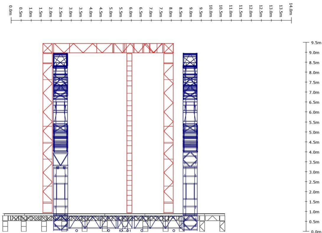
**3.5. Bastidores e Testeira:** Estrutura fabricada em “Box Truss” P.30 de liga de alumínio, em formato arredondado nas dimensões aproximadas de 30mx9mx9,5m (trinta metros de largura por nove metros de profundidade por nove metros e cinquenta centímetros de altura).
